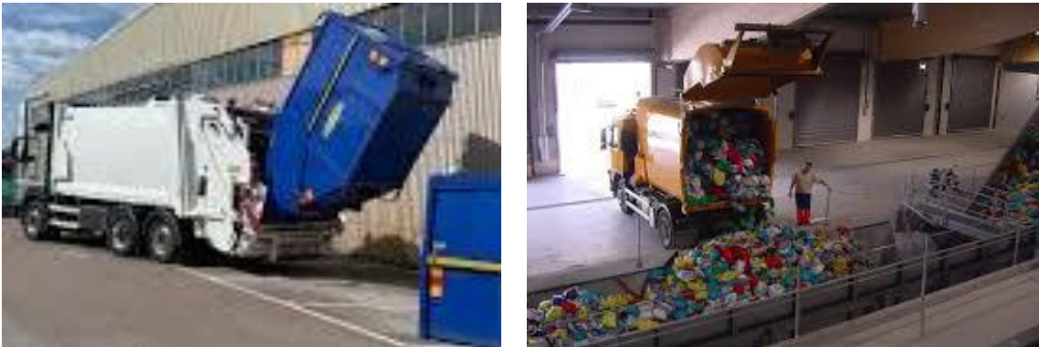
Պատկեր 32. Բարձր տարողությամբ կոնտեյներներ (ձախից) և դրանց դատարկման համակարգ (աջից)
