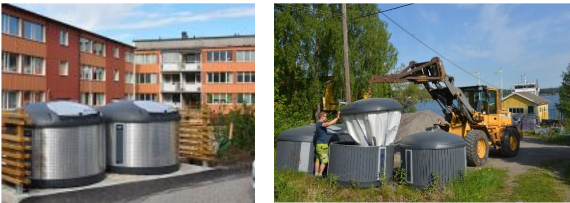
Պատկեր 32. Բարձր տարողությամբ կոնտեյներներ (ձախից) և դրանց դատարկման համակարգ (աջից)
