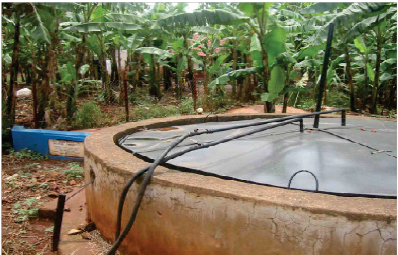
Կենսագազի ստացման տեխնոլոգիա. կենսագանգվածի խմորման փոքր կայան գյուղական տնտեսությունում
