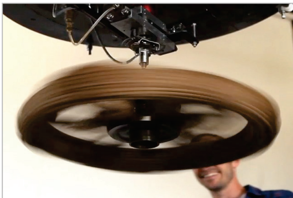
Նկար 22. Velkess Energy Storage /Էներգակուտակիչ/ համակարգի նախատիպը մի կատարելագործված թափանիվ է՝ նախատեսված ավելցուկ արևային ֆոտովոլտայիկ էներգիան որսալու համար, որը վերածվում է կինետիկ էներգիայի և օգտագործվում ցածր արևային լույսի կամ գիշերային ժամերին:
